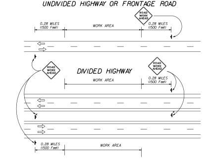
TRAFFIC CONTROL PLAN FOR WORK OFF OF THE PAVED SURFACE.
